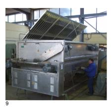
In fast allen Größen lieferbar: Schnecken- Ø von 500- 2500, Rollen- Ø 100 und 150, Rollenlängen 2000- 4000 mm
